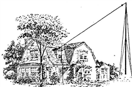
Fig. 58. — ANTENA INCLINADA, UN SOLO HILO.
